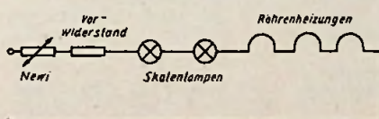
Abb. 11. Zeitverzögerungsglied mit Newi-Halbleiter für die Serienheizung
