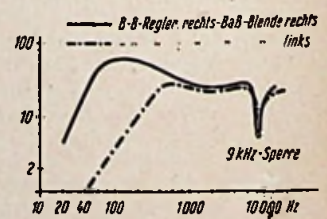
Frequenzgang des NF-Teils der Siemens-Schaltulle Super SB 700 W. Bei UKW 9-kHz-Sperre abgetrennt
